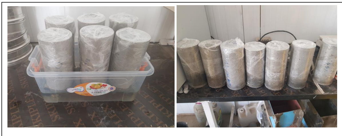
Figure II.46 : L'essai d'absorption capillaire.
