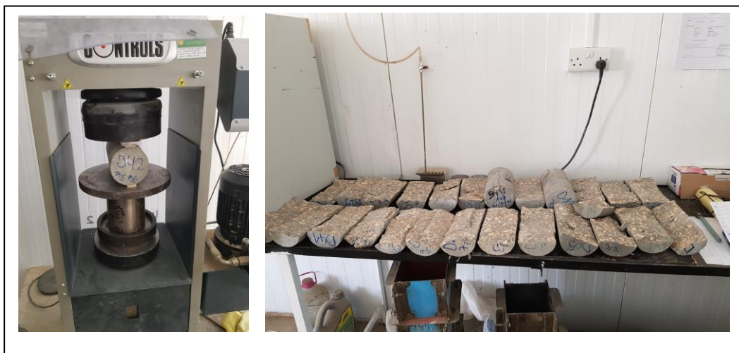
Figure II.44 : Ecrasements des éprouvettes cylindriques à l'essai de fendage.
