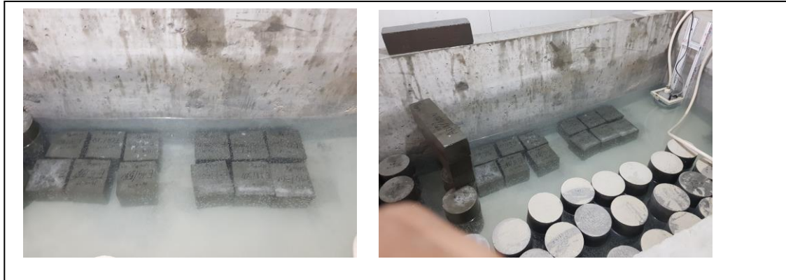
Figure II.34 : Conservation des éprouvettes dans le milieu non agressif
