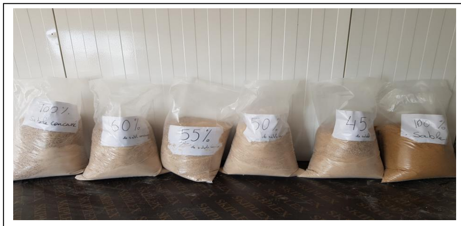
Figure II.1 : Substitution de sable naturel avec du sable concassé.
