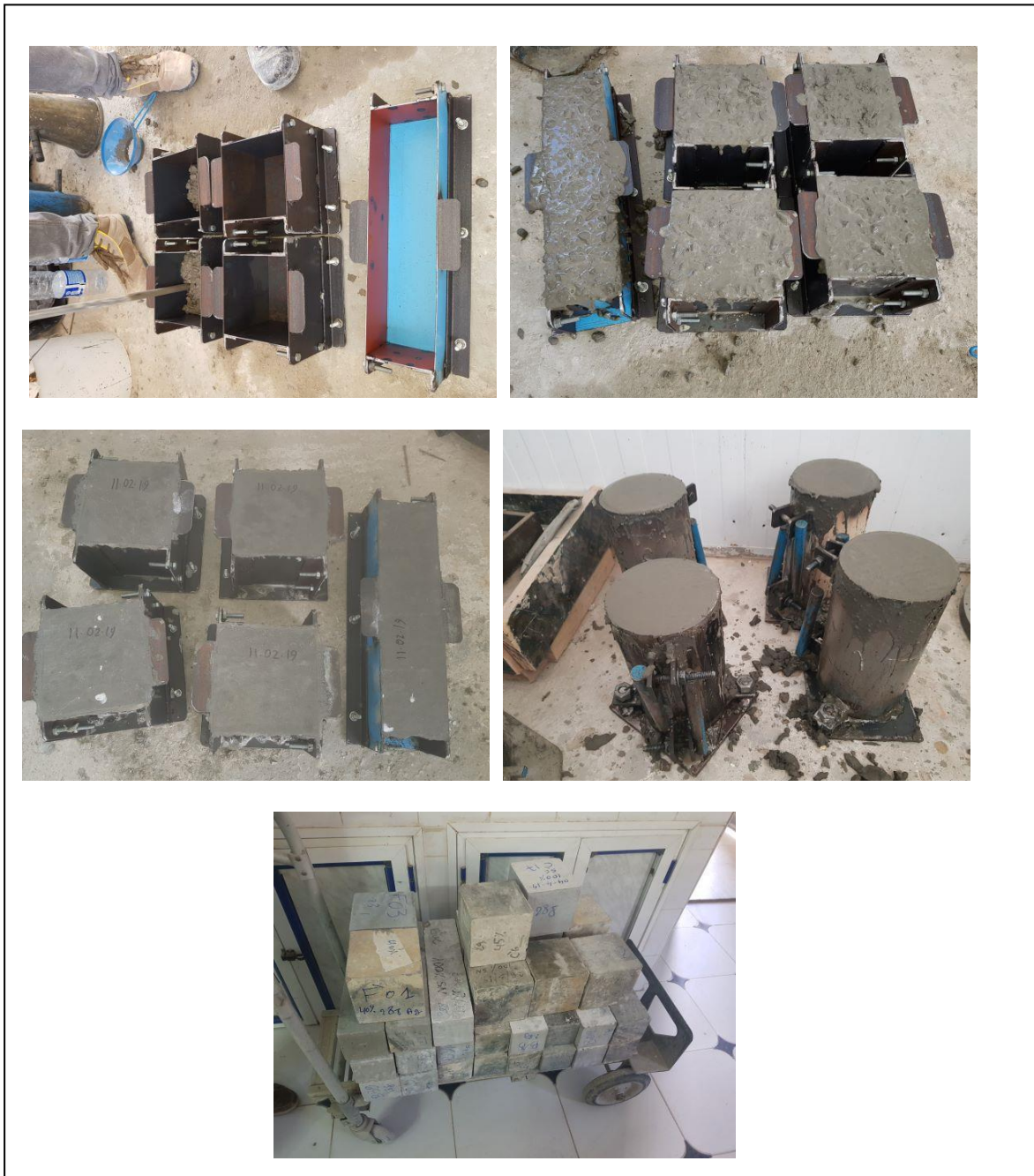
Figure II.32 : Prélèvement des éprouvettes de béton.
