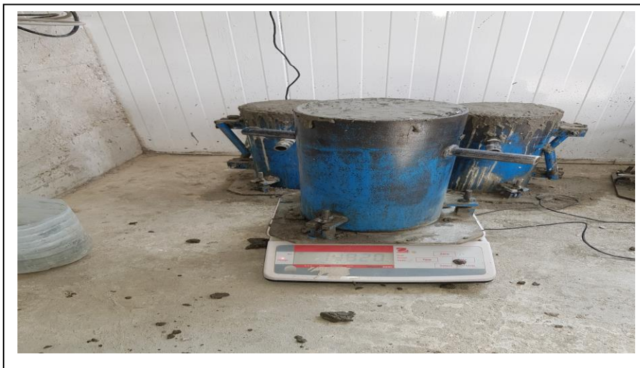
Figure II.39 : Détermination de la masse volumique du béton état frais.
