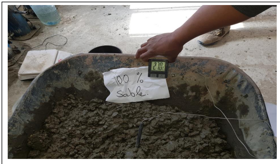
Figure II.35 : Mesure de température de béton
