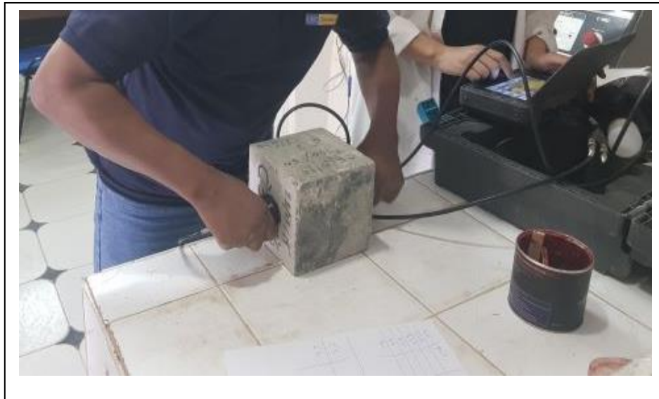
Figure II.48 : L'essai d'auscultation dynamique.
