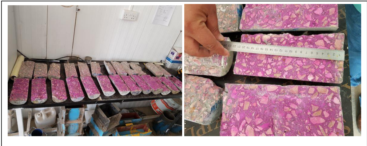
Figure II.49 : L'essai de carbonatation.
