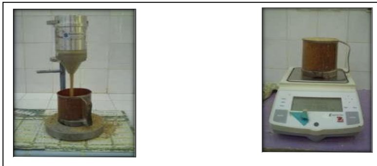
Figure II.13 : Essai de détermination de la masse volumique apparente.
