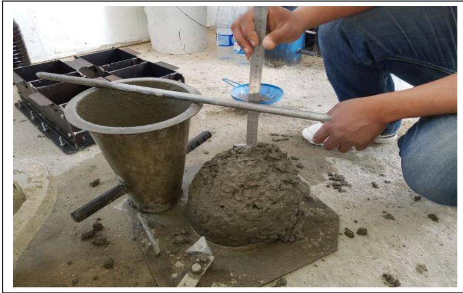
Figure II.38: Mesure de l'affaissement au mélange M0 avec E/C=0.42
