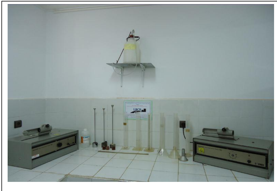
Figure (II.11) : Dispositif d'essai d'équivalent de sable
