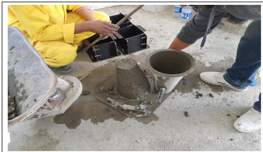
Figure II.37 : Mesure de l'affaissement au mélange M0 avec E/C=0.35 .
