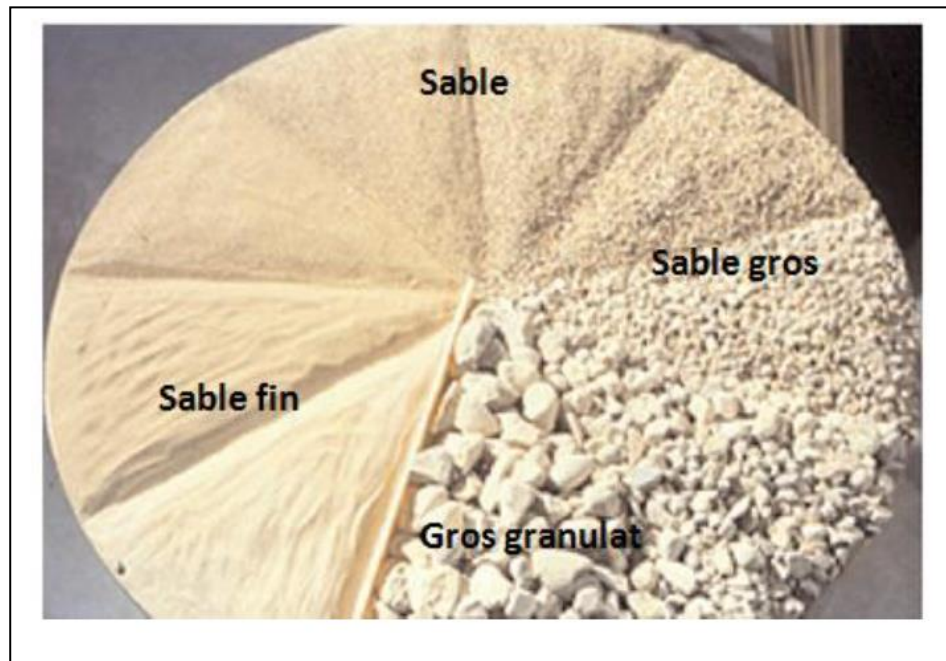
Figure I.3 : Les différentes dimensions des granulats. [5]
