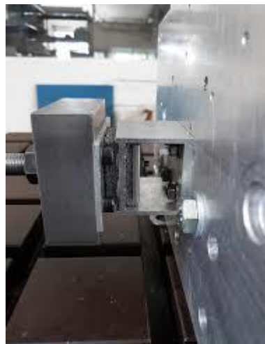
Figure 2.18: compression simple ou répété
