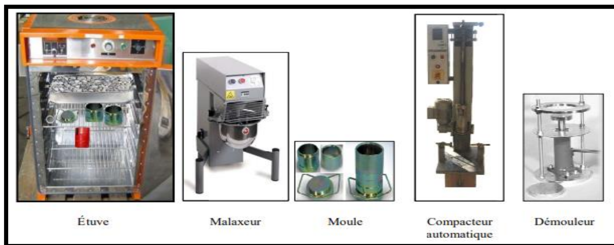
Figure 6.2 : Matériels utilisés pour fabrication des éprouvettes
