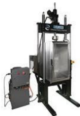
Figure 2.14: retrait thermique empêché (AASHTO, TP10-93)
