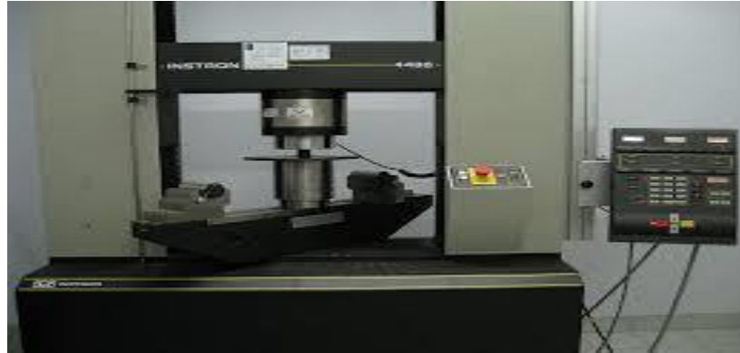
Figure 2.15 : Rupture par Compression Diamétrale.
