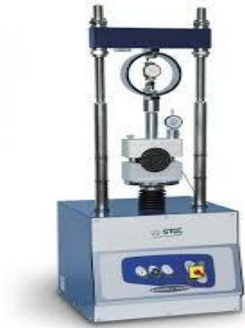
Figure 4.7 : Essai Marshall pour les enrobés.
