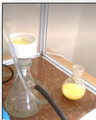
الصورة (6-IV): عملية الترشيع تحت الفراغ. الصورة (7-IV): عملية إعادة بلورة السند ( L_1 ).
