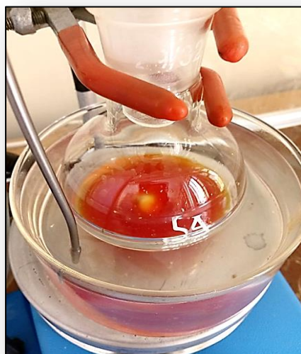
الصورة (15-IV): التركيب التجريبي الخاص بالتحضير العضوي للمعقد ( \text{NiL}_1 ).
