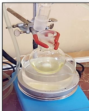
الصورة (19-IV): التركيب التجريبي الخاص بالتحضير العضوي للمعقد ( \text{CuL}_3 ).
