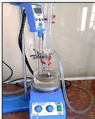
الصورة (IV-13): التركيب التجريبي الخاص بالتحضير العضوي للمعقد ( \text{CuL}_1 ).
