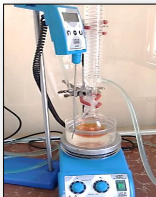
الصورة (8-IV): التركيب التجريبي الخاص بالتحضير العضوي للسند ( L_2 ).
