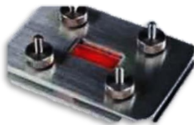
الصورة (4-II): خلية العينات السائلة في تقنية FT-IR [13] .
