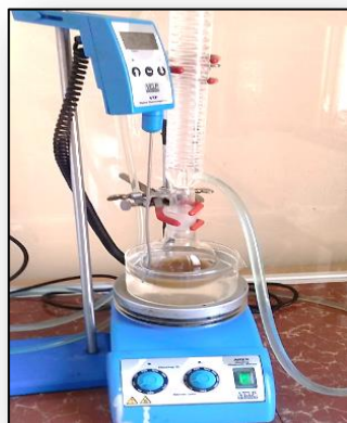
الصورة (IV-17): التركيب التجريبي الخاص بالتحضير العضوي للمعقد ( \text{CuL}_2 ).
