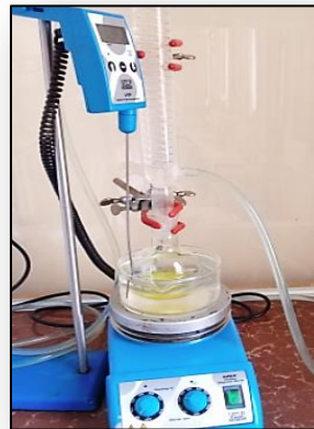
الصورة (IV-13): التركيب التجريبي الخاص بالتحضير العضوي للمعقد ( \text{CuL}_1 ).
