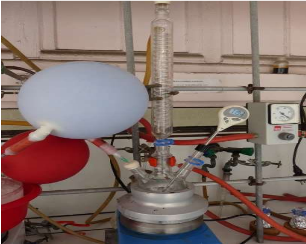
Figure 8 : Montage au reflux pour la polymérisation radicalaire.
