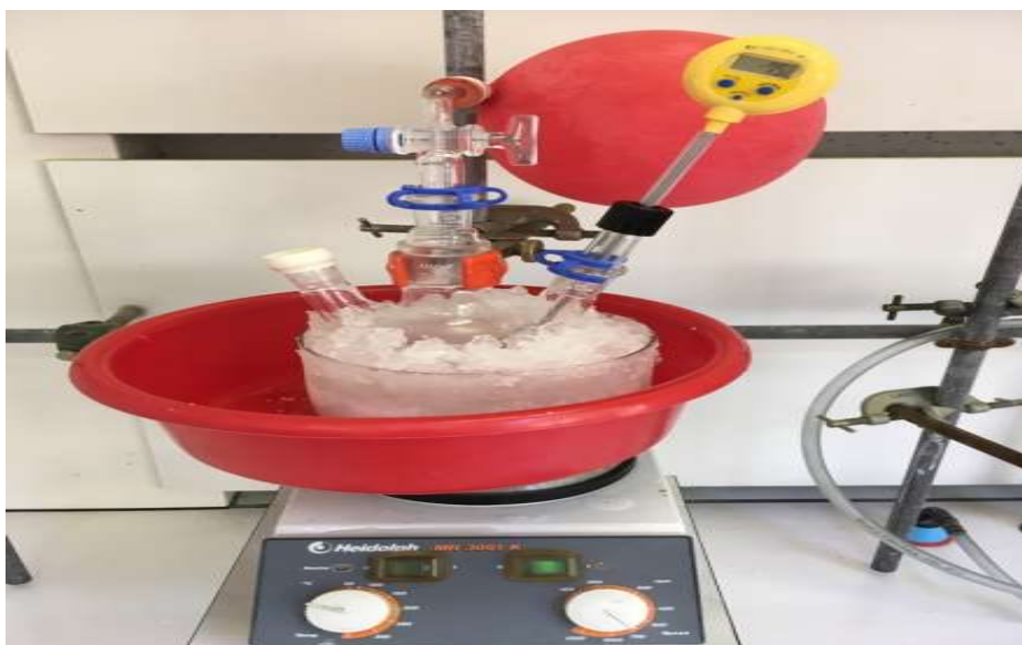
Figure 2 : Montage de la polymérisation anionique du MMA
