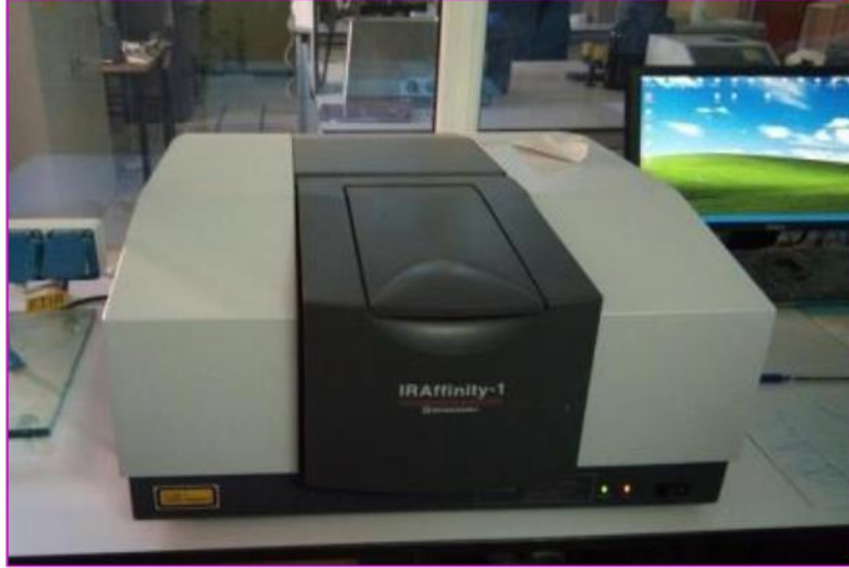
الشكل II-11: جهاز الأشعة تحت الحمراء المستخدم في الدراسة.
