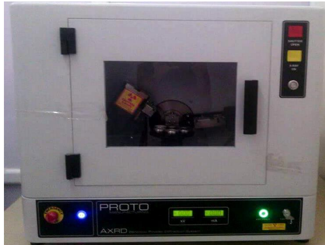
الشكل (7-II): جهاز الانعراج الآلي من نوع PROTO AXRD Benchtop .
