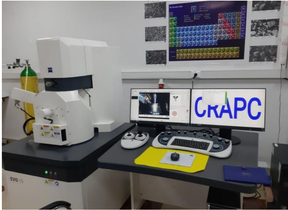
الشكل II-13: جهاز الماسح الضوئي المربوط بجهاز تشتت الطاقة السينية من نوع Zeiss Evo15.
