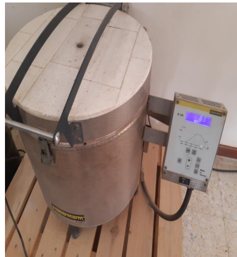
الشكل II.3. الفرن الكهربائي المستعمل للتسخين والأواني الخزفية
