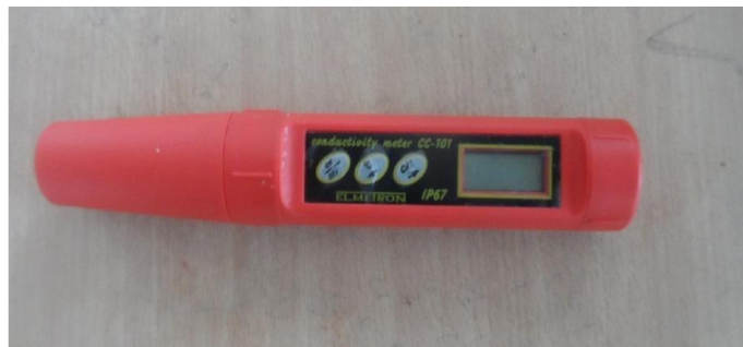
Figure IV. 8: conductimètre pour mesurer les différentes conductivités de pollution utilisées aux essais.
