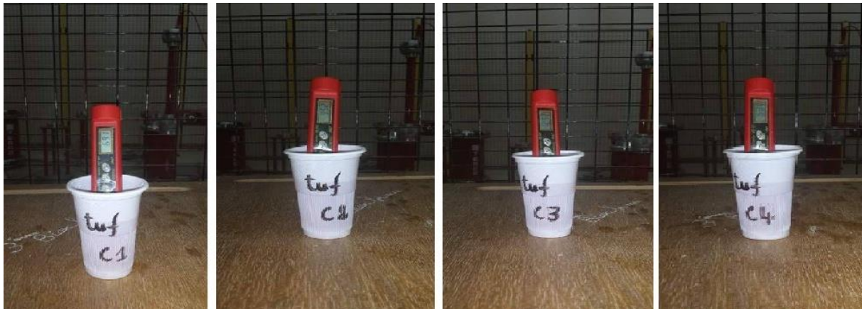
Figure IV.30: mesures des différentes concentrations de tuf dans l'eau distillée.
