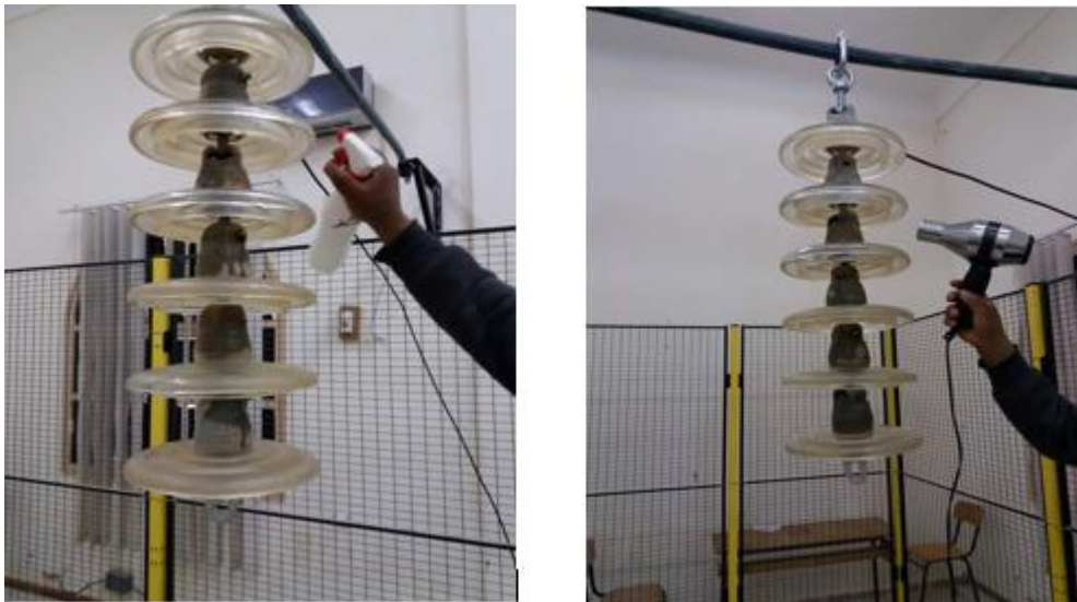
Figure IV.5: opération de nettoyage et séchage d'isolateur.
