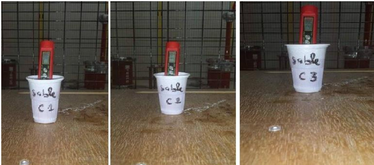
Figure IV.23: Mesures des différentes concentrations du sable dans l'eau distillé.
