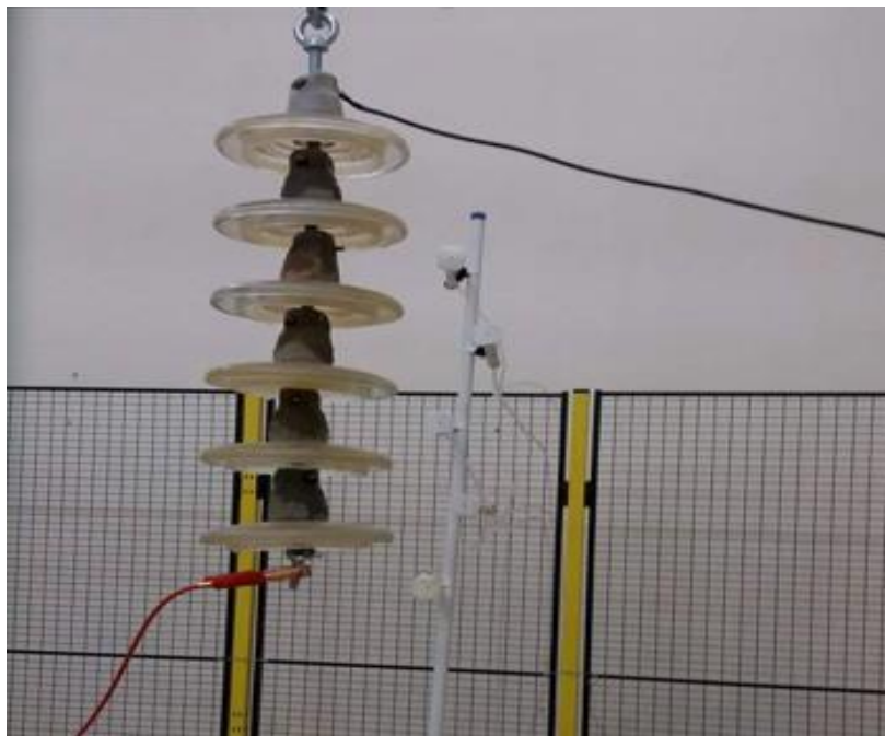
Figure IV.2: Circuit d'essai à fréquence industrielle.
