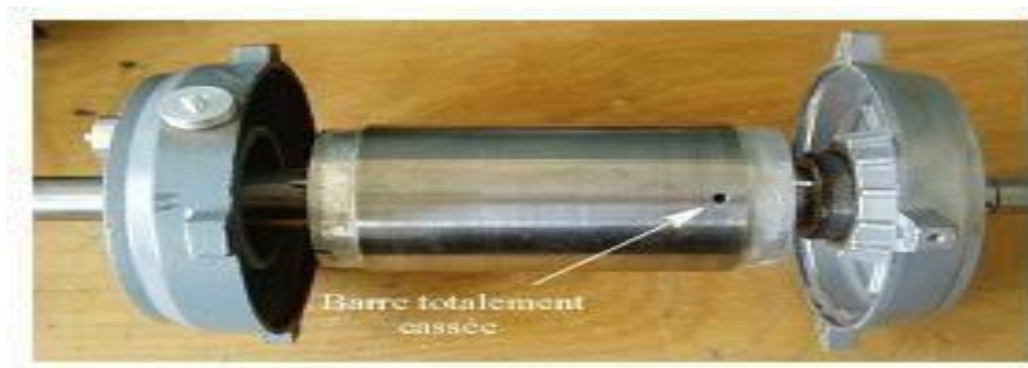
Fig.I.5. Défaut d'une barre cassée.
