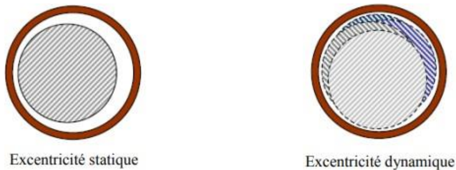
Fig.I.7. Modélisation schématique de l'excentricité statique et dynamique
