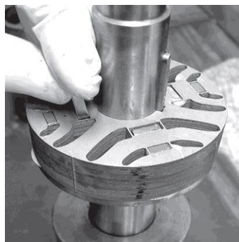
Figure I.9 Positionnement des aimants permanents dans le PM-synRM
