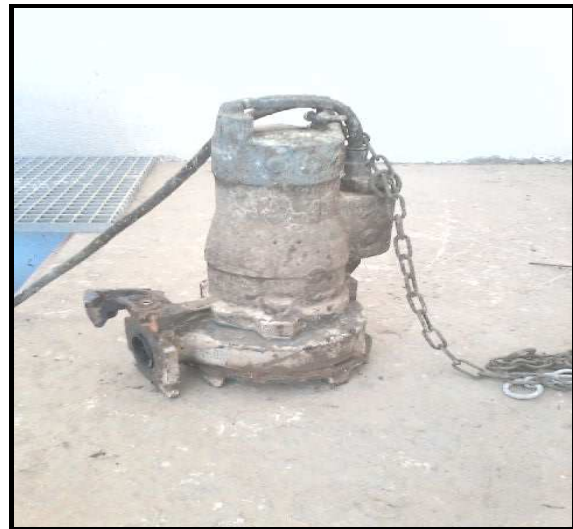
Photo II-10: La bête de Station de refoulement est pleine par l'averse et problème de pompage
