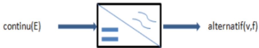
Figure 1.9: Schéma bloc représentatif d'un onduleur
