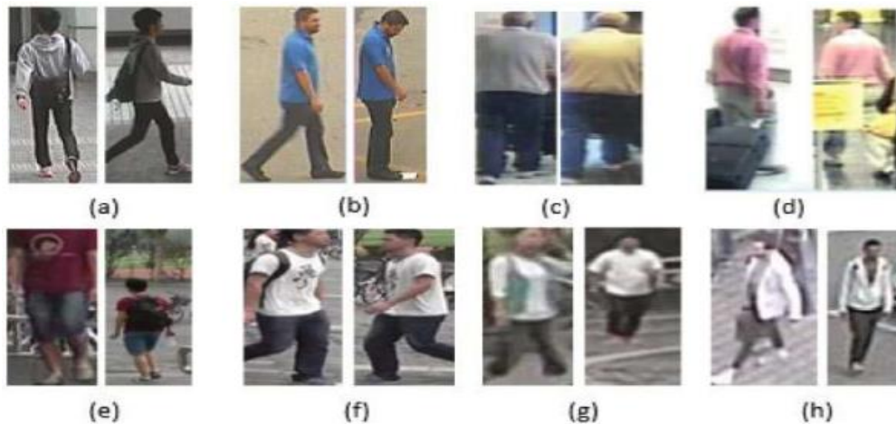
Figure 1.10: Exemple de quelques défis de ré-identification de personnes. Chaque paire d'images montre la même personne sauf (g). (a) Variation du point de vue, (b) variation de la pose, (c) changements d'éclairage, (d) occlusion partielle, (e) détection de piétons inexacte, (f) changement d'accessoires, (g) basse résolution et (h) personnes différentes avec des vêtements similaires.
