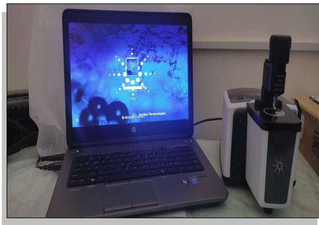
Figure 15 : Spectromètre FTIR Cary 630.(original)
