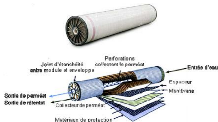
Figure (I.7) : Module à membrane spiralée
