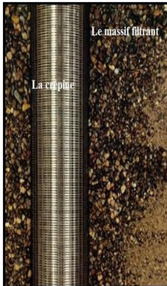
Figure 32 : Emplacement du massif filtrant dans le forage
