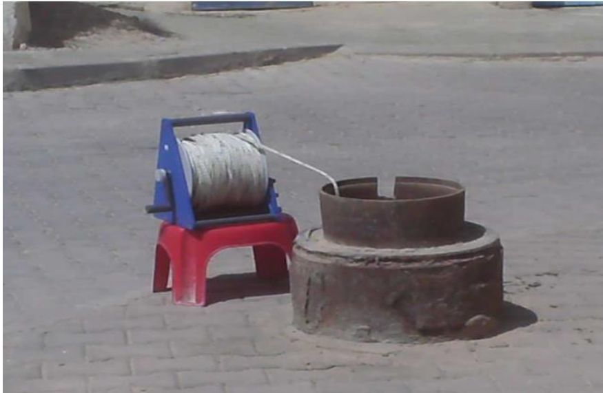
Figure 39 : La mesure par sonde piézométrique (forage Guemar-Est)
