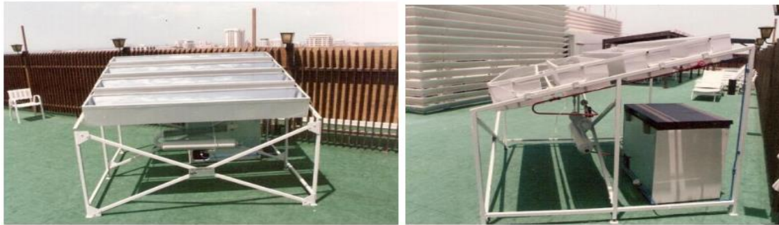
Figure I.7 : vue de Réfrigérateur solaire Coldfego
