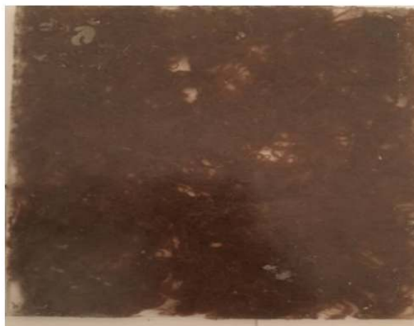
الشكل 33: صفيحتين الالياف بعد صب الراتنج للوبر و نخل الزينة
