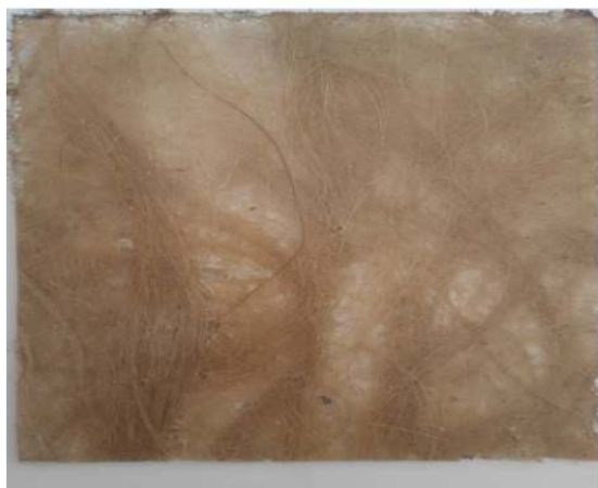
الشكل 33: صفيحتين الالياف بعد صب الراتنج للوبر و نخل الزينة
