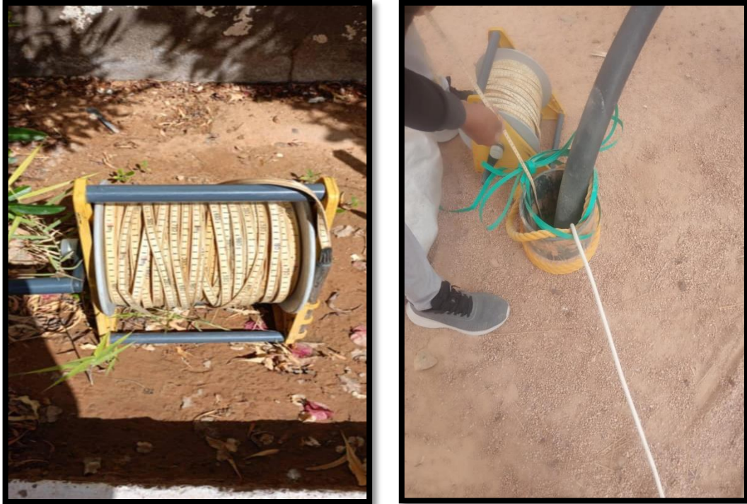
Photo III.7. Appareil de mesure de niveau statique
