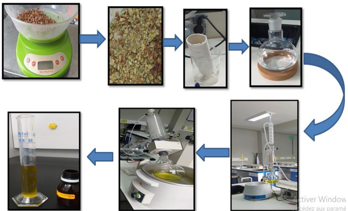
Figure16 : Différentes étapes d'extraction d'huile de Neem (Originale, 2021)
