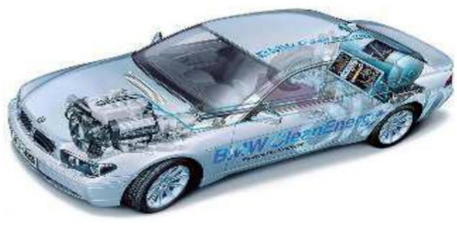
Fig I.3: Moteur et stockage cryogénique [15]
