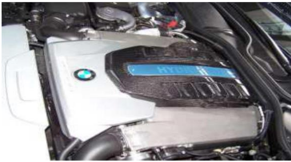
Fig I.3: Moteur et stockage cryogénique [15]
