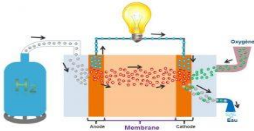
Fig I.4: Pile à combustible [8.9]
