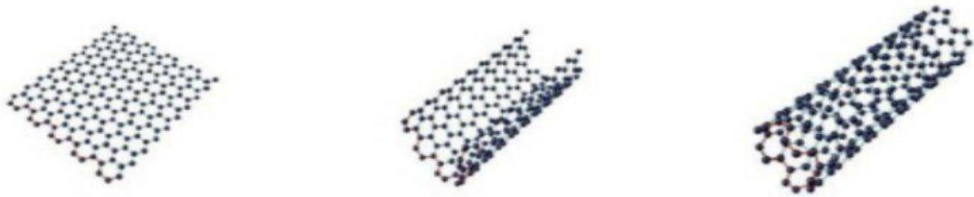
الشكل (8-I): التفاف صفيحة الغرافيت لتشكيل الأنابيب النانوي [23]
