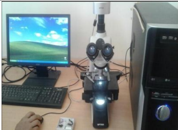
Microscope optique de type OPTIKA lié à un appareil photo (photo originale).
