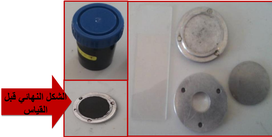
الشكل (8-III): أدوات تحضير عينة للقياس بواسطة جهاز الإنعراج الآلي.
