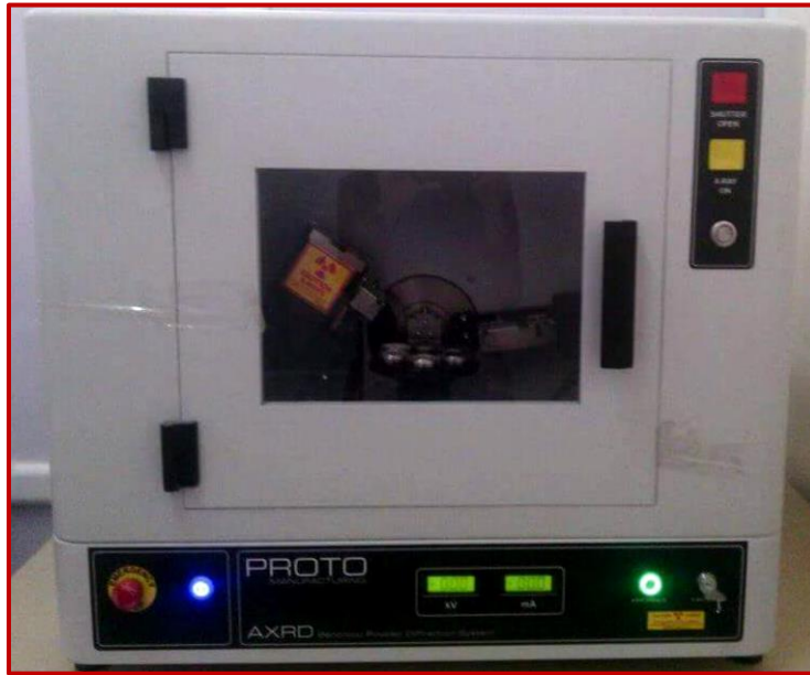
الشكل (III-7): جهاز الانعراج الآلي من نوع PROTO AXRD Benchtop .
