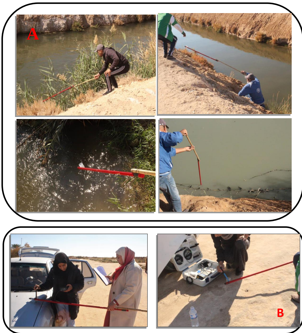
Photo 03 : (A) Prélèvements des échantillons d'eau ; (B) Mesure des paramètres in situ (Messaoudi & Bouchemal ,2023)
