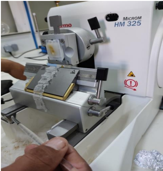
Figure 14: effectuation des coupes avec le microtome.
