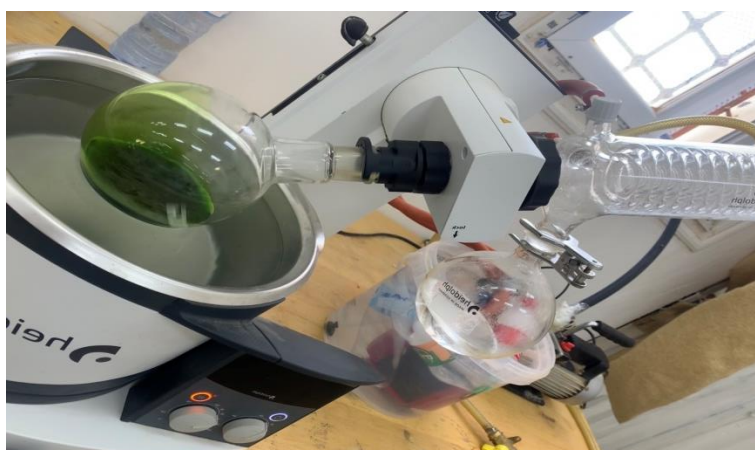
الصورة (08): توضح عملية فصل الهكسان عن المستخلص.
