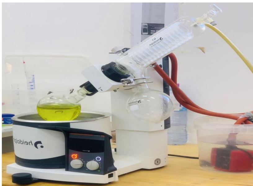
الصورة (07): توضح عملية فصل بترول الايثر عن المستخلص.
