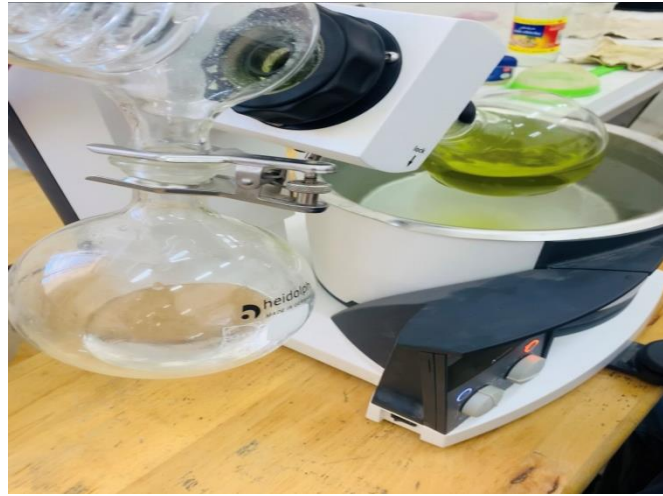
الصورة (09): توضح عملية فصل الايثانول عن المستخلص.
