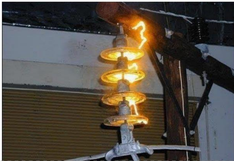
Figure I.2 : Phénomène de contournement dans un isolateur .[9].
