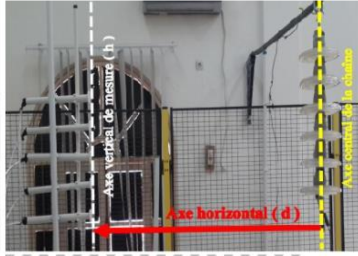
Figure I.9: La chaîne des isolateurs utilisée et les axes de mesure du champ
