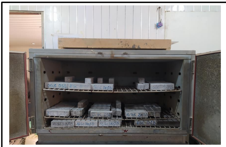
Figure II.15 Mise à l'étuve des éprouvettes à une température de 105°.
