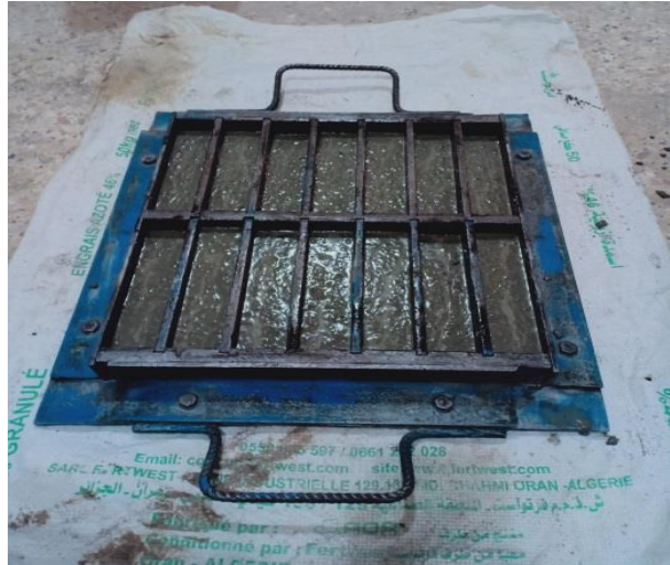
Figure II.10. Remplissage à moitié et vibration
