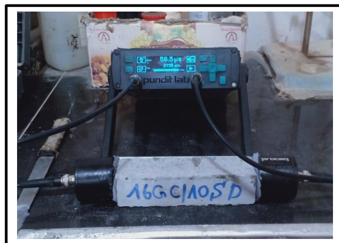
Figure II.18 Mesure de la vitesse de propagation de sons sur des éprouvettes (4x4x16) cm 3
