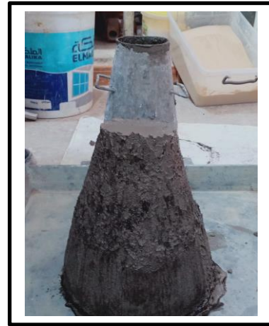
Figure II.14b. L'essai d'affaissement au cône d'Abrams après le démoulage
