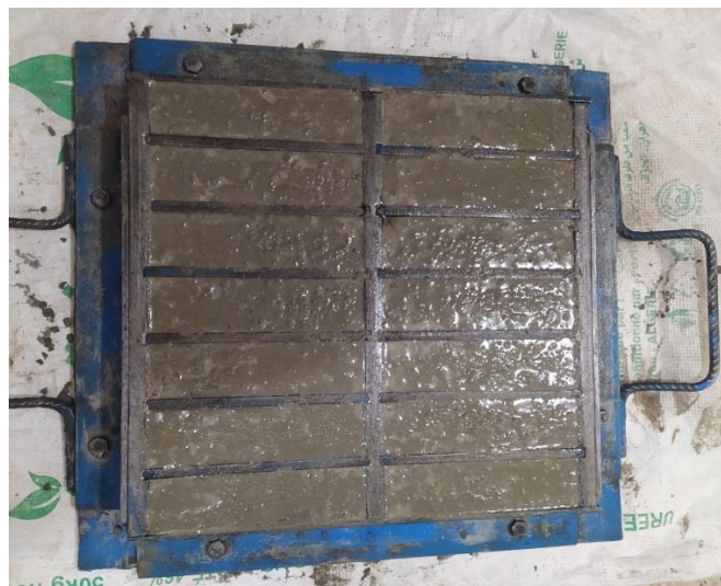
Figure II.11. Remplissage total et vibration.
