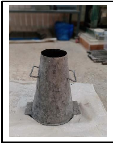
Figure II.14a. L'essai d'affaissement au cône d'Abrams avant le démoulage.
