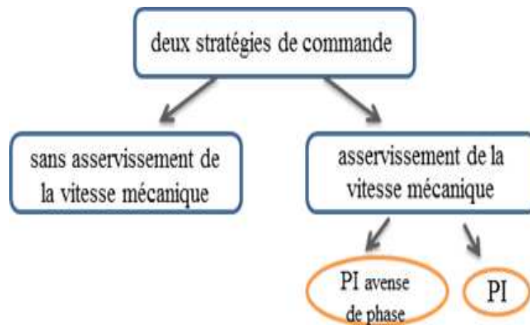
Figure II.17 Stratégies de commande de la turbine
