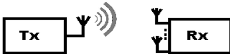
Fig.1.2 SIMO – Entrée Unique Sortie Multiple[1]
