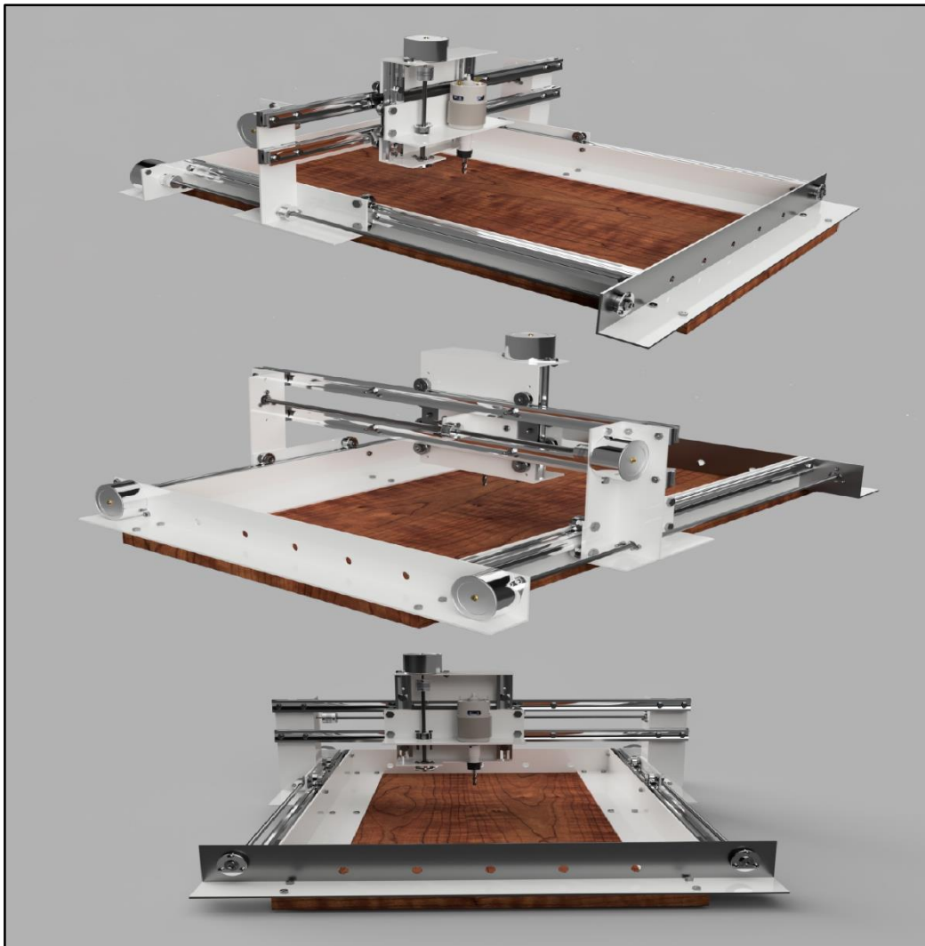
Figure II.1 : Conception la machine CNC à trois axes (MOCN).
