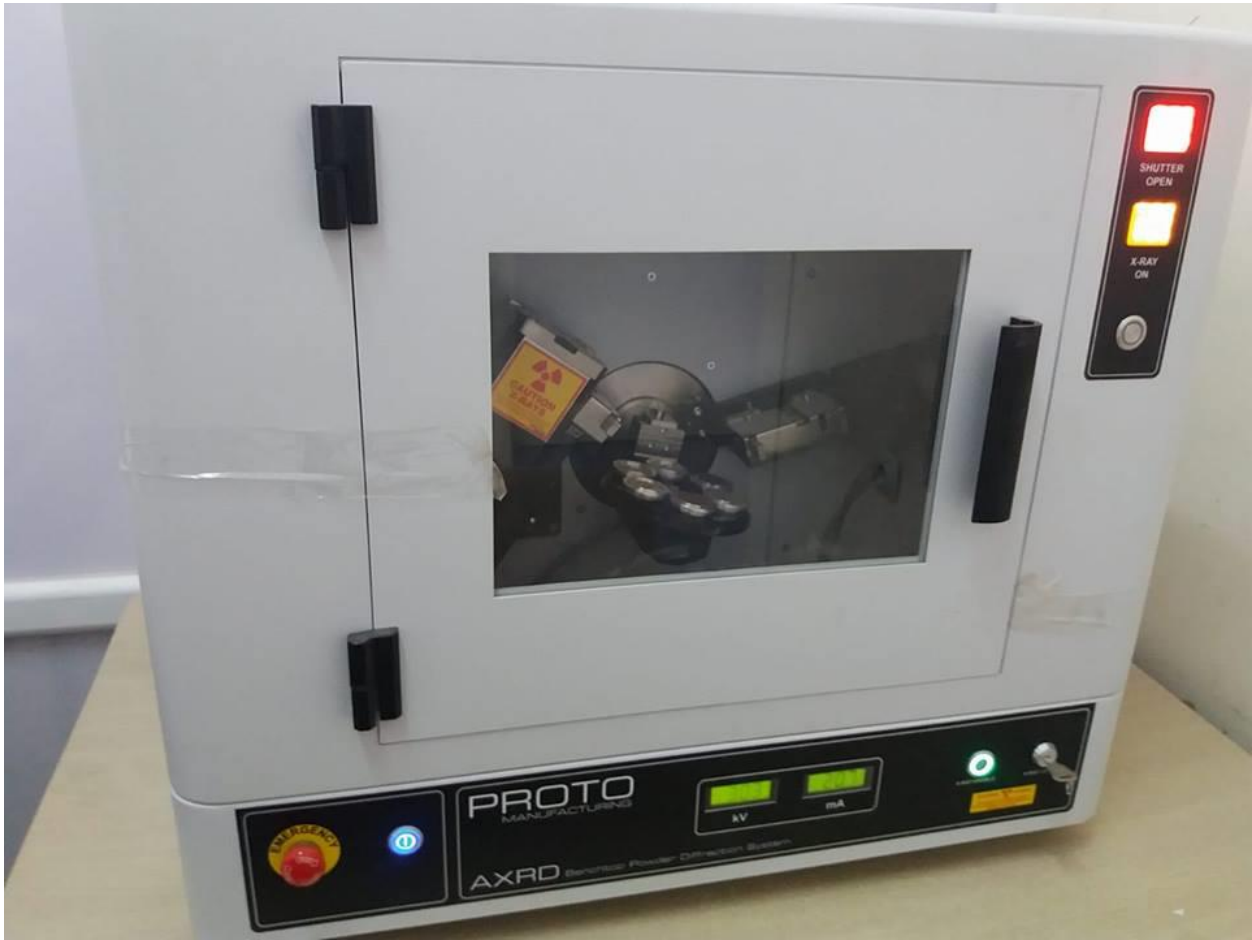
الشكل (10-2): جهاز انعراج الأشعة السينية المستعمل
