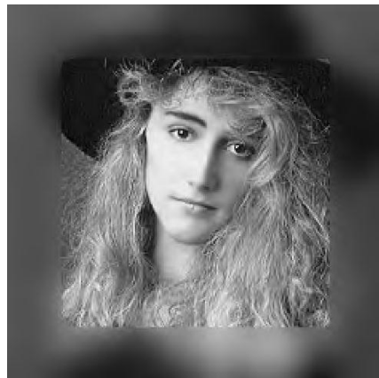
Figure IV.19 : Image Hoed reconstruite 256×256 par SPECK modifié avec ondelettes (TC=91% et PSNR=32.00 dB).
