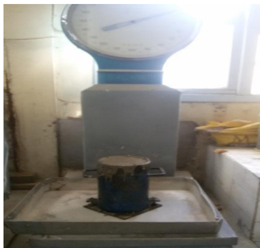
Figure II.13 : Mesure de la masse volumique à l'état frais.
