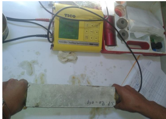
Figure III.6: Détermination de La vitesse de propagation des ondes ultrasons.
