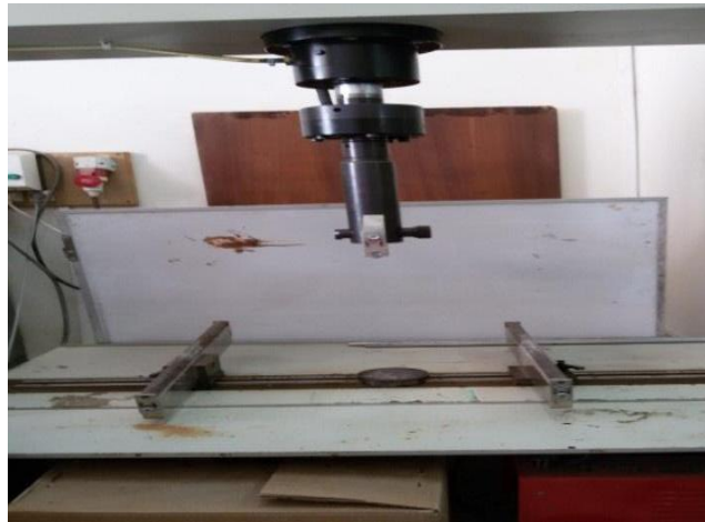
Figure II.15 : Machine d'essai de Traction par flexion.
