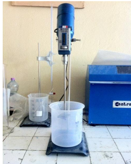
Figure II.9 : Appareil pour détermine la valeur de bleu méthylène.
