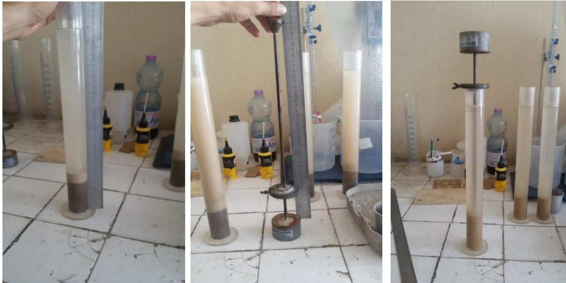
Figure II.8 : L'essai au piston de l'équivalent de sable.
