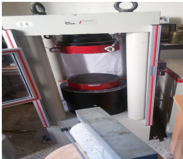
Figure II.14 : Machine d'essai de Traction par fendage.
