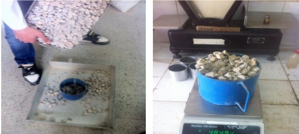
Figure II.6 : détermination de la masse volumique apparente.
