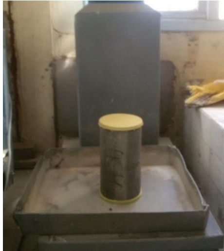
Figure I.21: Mesure de la masse volumique du béton durci.
