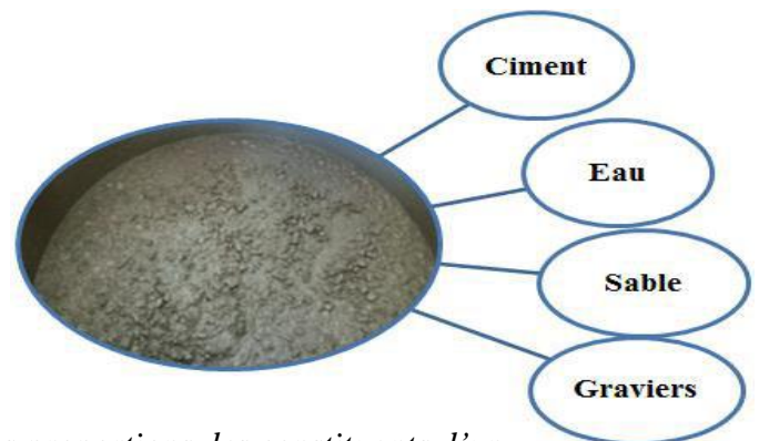
Figure II.1: Constituants et ordre de grandeur des proportions des constituants d'un Béton ordinaire [3].
