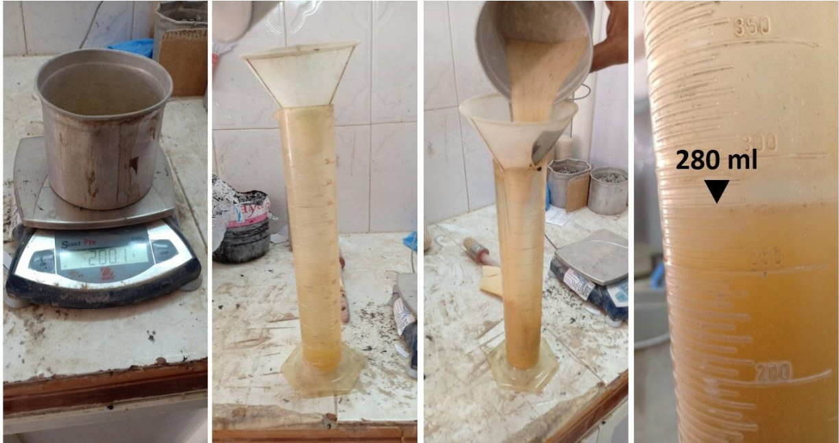
الشكل 2.6 : صور خطوات تجربة الكتلة الحجمية المطلقة
