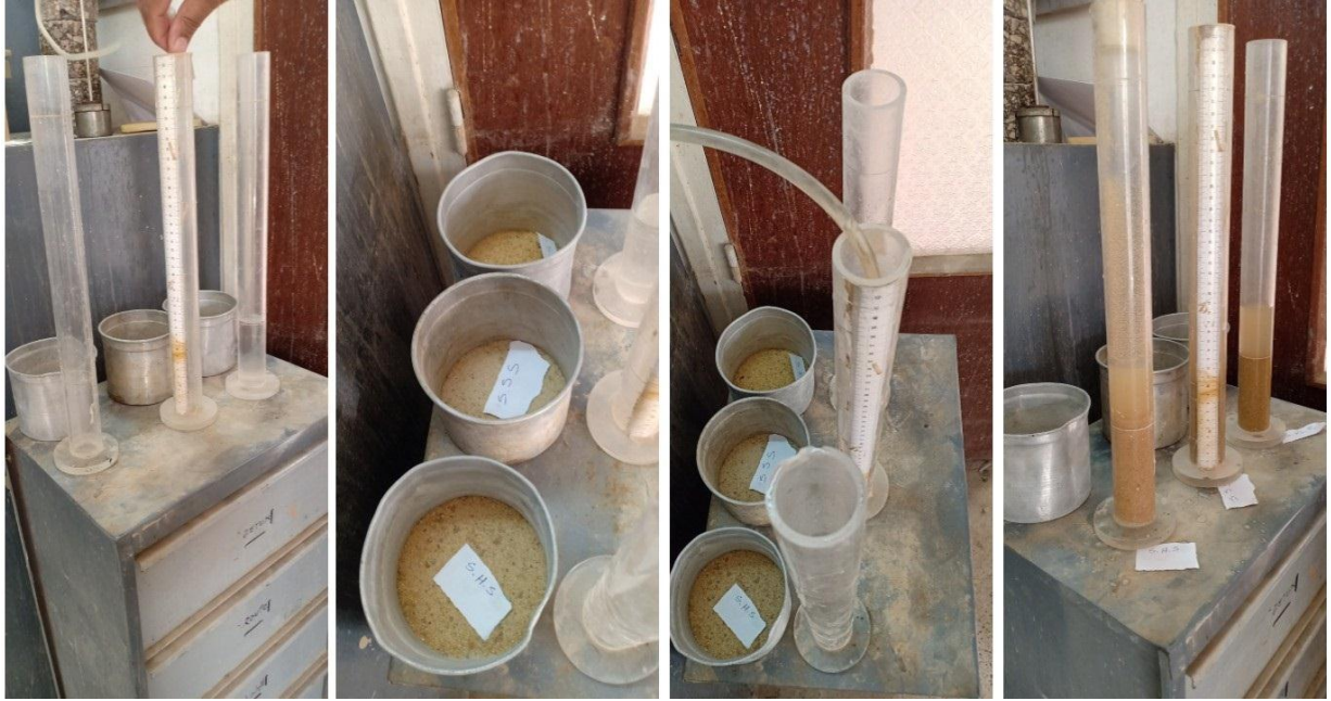
الشكل 2.4 : خطوات عمل تجربة المكافئ الرملي
