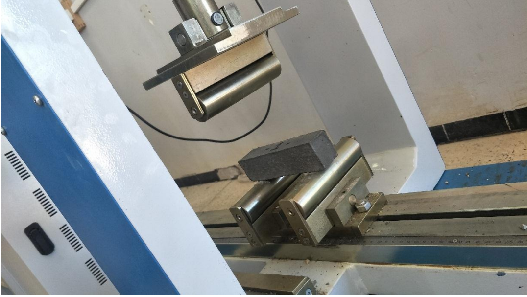
الشكل 2.10 : آلة التحطيم الخاصة بتجربة الإنحناء وطريقة وضع العينة
