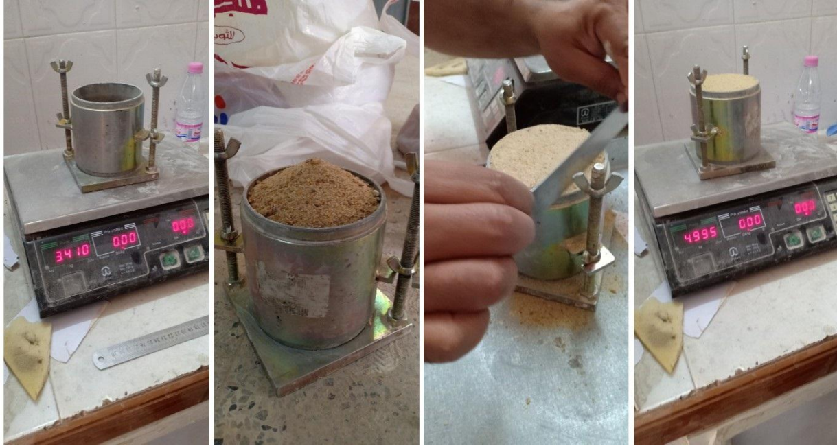
الشكل 2.7 : خطوات تجربة الكتلة الحجمية الظاهرية
