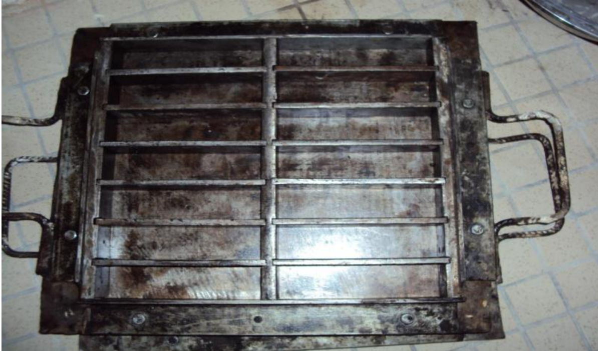
الشكل 3.1 : توضيح أشكال القوالب المستعملة
