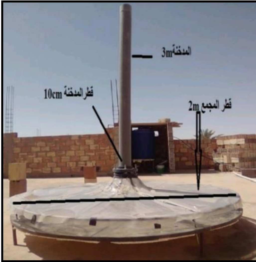
الشكل (3-3): صورة تبين نموذج التجريبي للمدخنة الشمسية في ولاية وادي سوف
