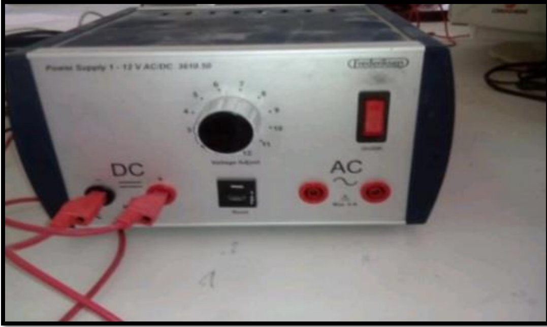
الشكل (3-6) صورة تبين المولد الكهربائي
