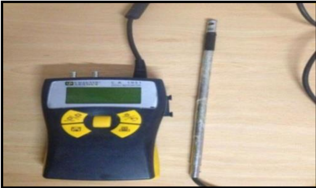
الشكل (3-7): صورة تبين جهاز لقياس سرعة الهواء
