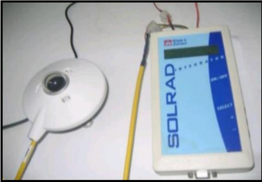
الشكل (3-5): صورة تبين جهاز قياس الإشعاع الشمسي
