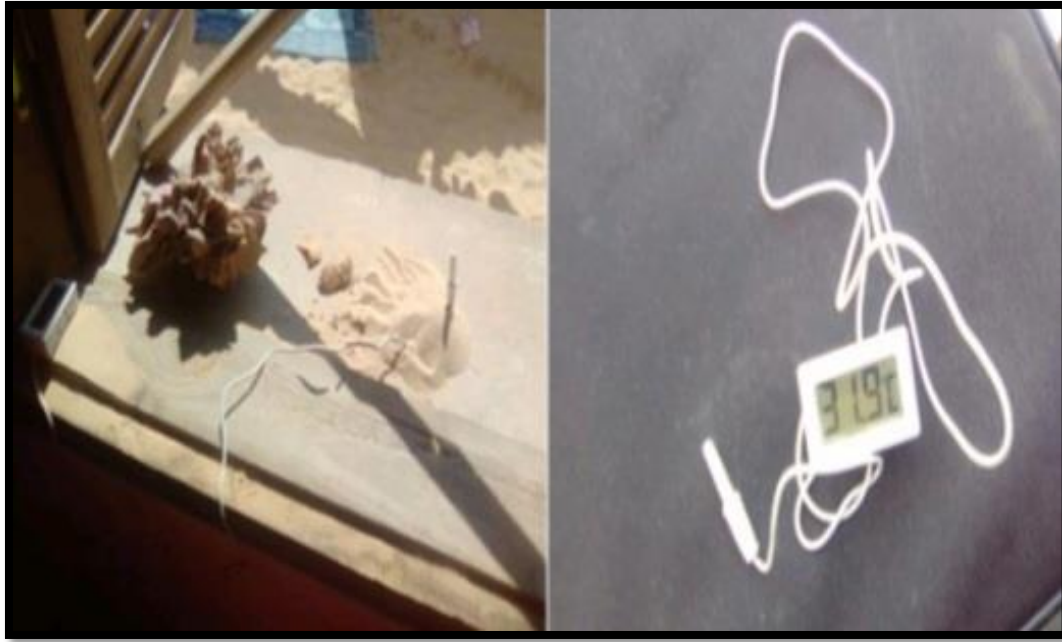
الشكل (3-8): صورة تبين جهاز الترموكابل لقياس درجة حرارة الجو
