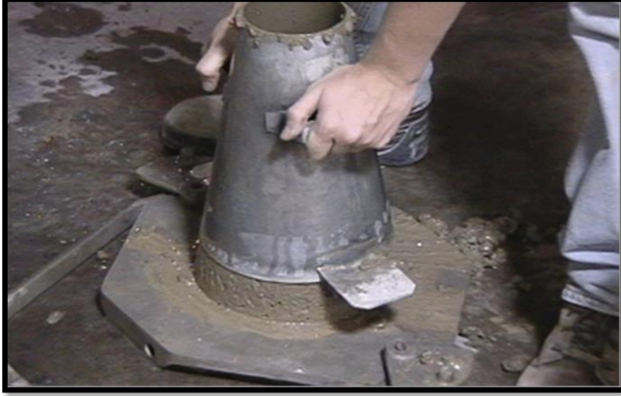
الشكل (VI-3) كيفية رفع القالب
