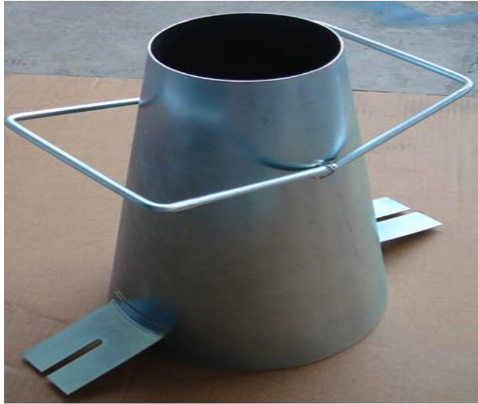
الشكل (VI-2) قالب اختبار الهبوط
