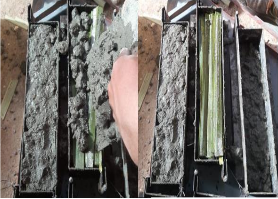
الشكل (VI-5) تحضير عينات خرسانة الالياف
