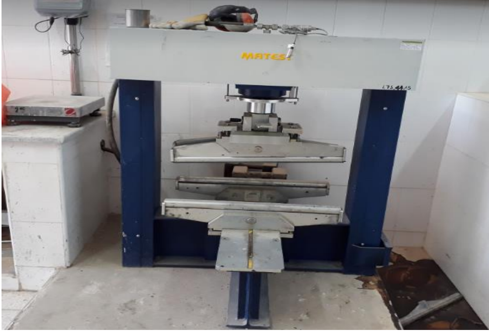
الشكل (VI-6) جهاز تجربة الانحناء
