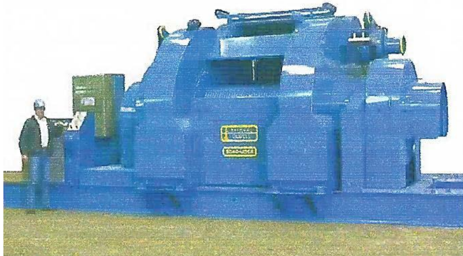
Figure I.4. Le treuil de forage
