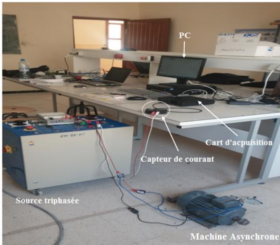
Figure III.13 : Schéma du principe de l'acquisition des résultats expérimentaux relative au courant statorique.
