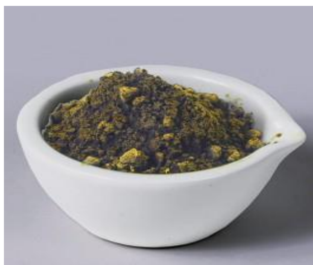
الشكل (III-3): مادة كلوريد الحديد ( FeCl_3 \cdot 6H_2O ) المستعملة في العمل التجريبي.
