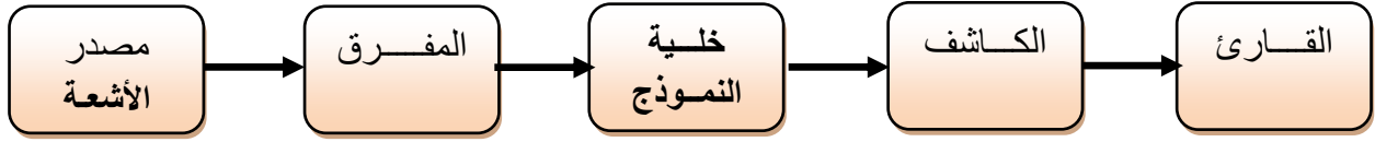
الشكل (1-II) رسم تخطيطي يوضح مكونات المطياف الاعتيادي.
