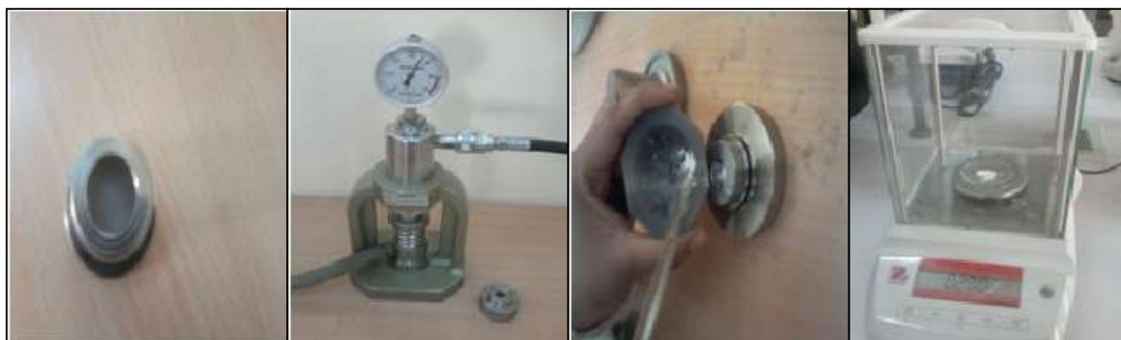
وزن المادتين وضع المسحوق في المكبس تشغيل جهاز الضغط وضع القرص الشفاف في حامل العينة
