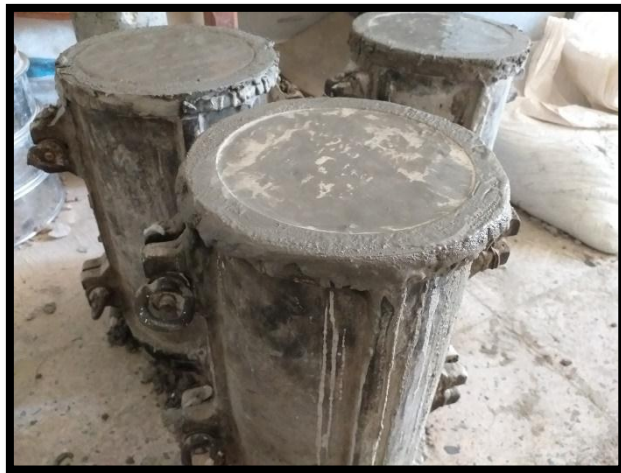
Figure II.28 : Conservation du béton au niveau de laboratoire.
