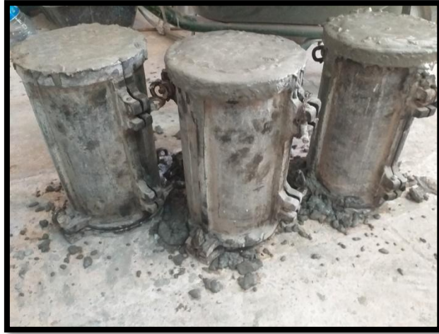
Figure II.27 : Mise en place des éprouvettes.
