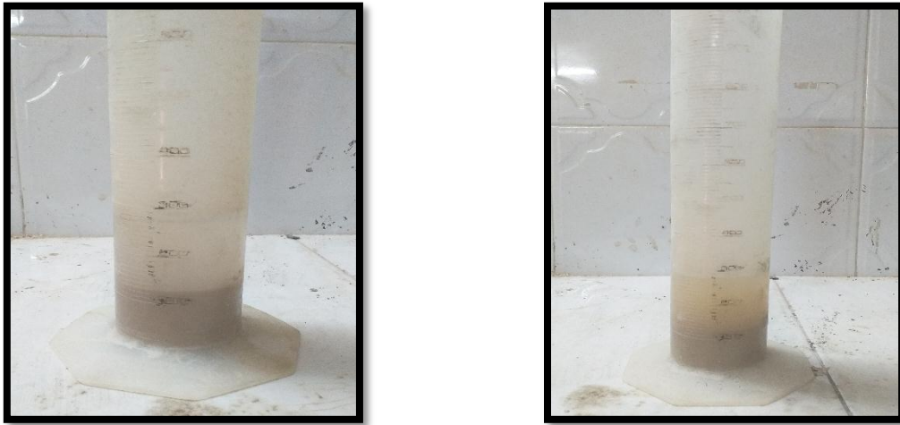
Figure II.11 : Essai de détermination de la masse volumique absolue du sable utilisé.
