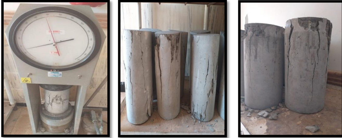
Figure III.5 : Exemple de différentes éprouvettes après l'écrasement.
