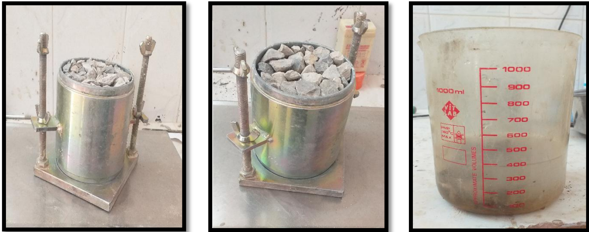
Figure II.15 : Essai de détermination de la masse volumique apparente et absolue du gravies utilisé.
