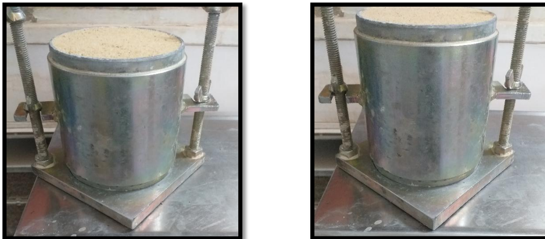
Figure II.12 : Essai de détermination de la masse volumique apparente du sables utilisé.
