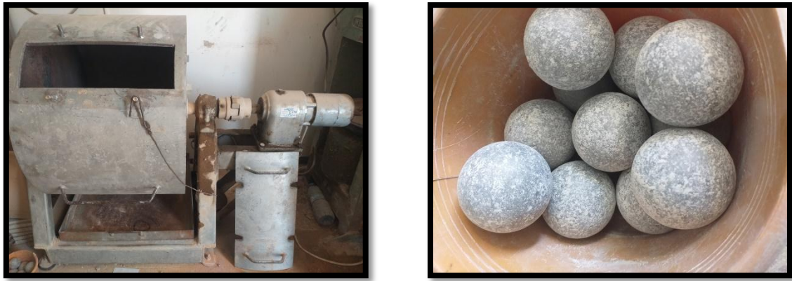
Figure II.16 : L'appareil de Los Angeles et les boules.
