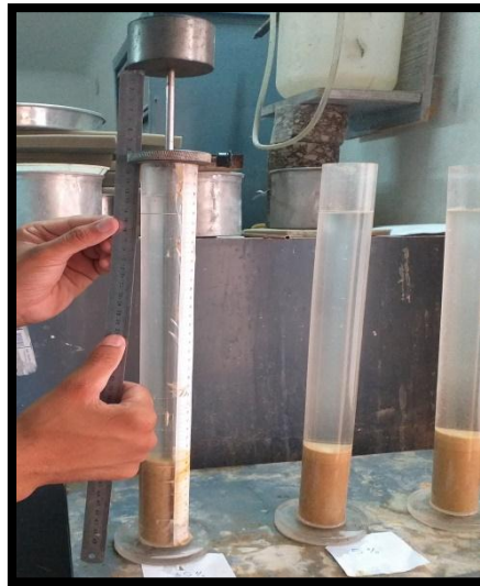
Figure II.10 : Essai de détermination de l'équivalent de sable.
