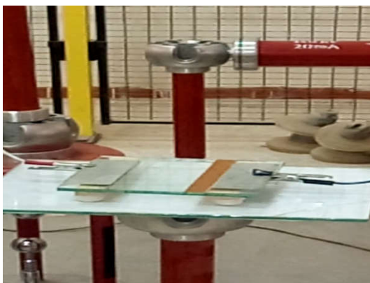
Figure III.40. Photo pollution en Argile coté terre, (a) largeur de pollution 2cm et (b) contournement du modèle polluée
