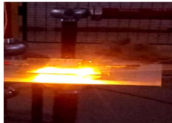
Figure III.11. Photo pollution en sable coté terre, (a) largeur de pollution 2cm et (b) contournement du modèle polluée
