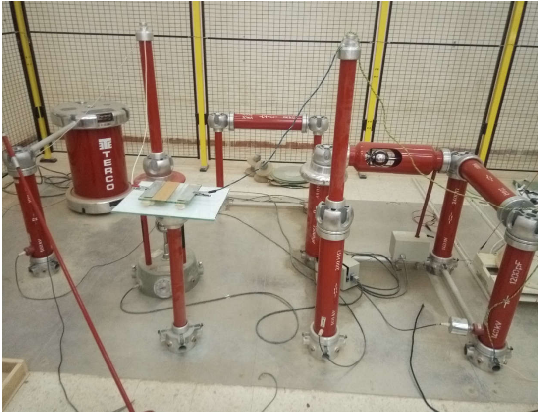
Figure III.3. Photo du circuit d'essai à fréquence industrielle
