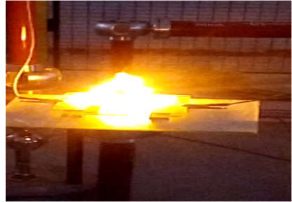
Figure III.12. Photo pollution en sable coté ht, (a) largeur de pollution 2cm et (b) contournement du modèle polluée
