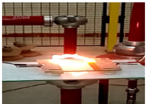
Figure III.40. Photo pollution en Argile coté terre, (a) largeur de pollution 2cm et (b) contournement du modèle polluée
