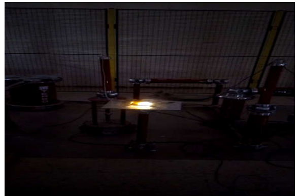
Figure III.42. Photo pollution en Argile coté ht, (a) largeur de pollution 4cm et (b) contournement du modèle polluée
