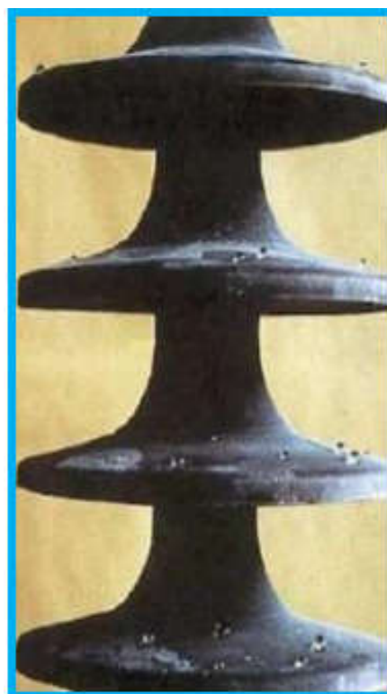
Figure I.13. photo Vieillissement d'un isolateur composite.
