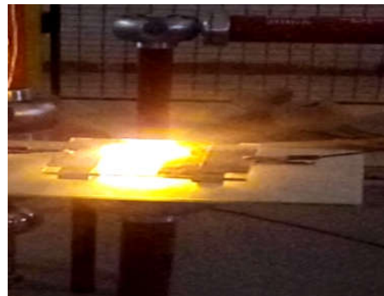
Figure III.13. Photo pollution en sable coté terre, (a) largeur de pollution 4cm et (b) contournement du modèle polluée
