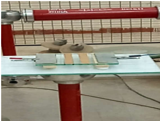
Figure III.35. Photo pollution discontinue en tuf, (a) largeur de pollution et (b) contournement du modèle polluée
