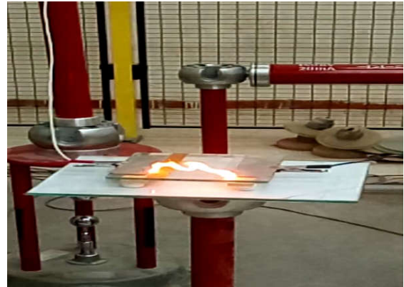
Figure III.39. Photo pollution en Argile coté ht, (a) largeur de pollution 2cm et (b) contournement du modèle polluée
