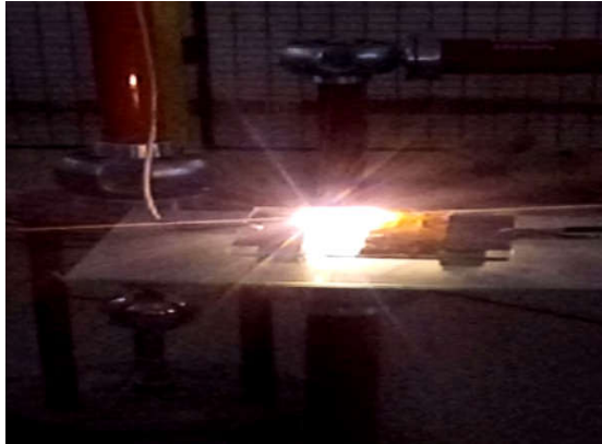
Figure III.29. Photo pollution en tuf coté terre, (a) largeur de pollution 6cm et (b) contournement du modèle polluée
