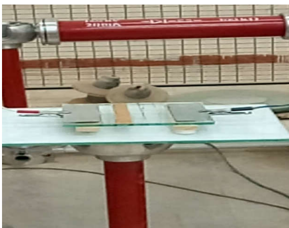
Figure III.36. Photo pollution discontinue en tuf, (a) largeur de pollution et (b) contournement du modèle polluée
