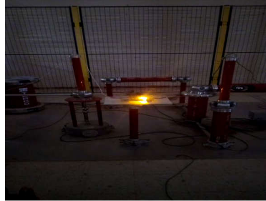
Figure III.31. Photo pollution en tuf coté terre, (a) largeur de pollution 8cm et (b) contournement du modèle polluée
