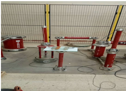
Figure III.42. Photo pollution en Argile coté ht, (a) largeur de pollution 4cm et (b) contournement du modèle polluée
