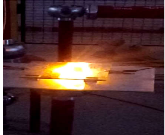
Figure III.27. Photo pollution en tuf coté ht, (a) largeur de pollution 4cm et (b) contournement du modèle polluée
