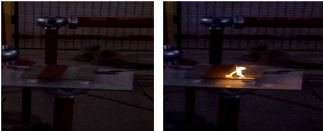
Figure III.43. Photo pollution en Argile coté ht, (a) largeur de pollution 6cm et (b) contournement du modèle polluée
