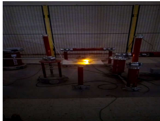
Figure III.17. Photo pollution en sable coté terre, (a) largeur de pollution 8cm et (b) contournement du modèle polluée
