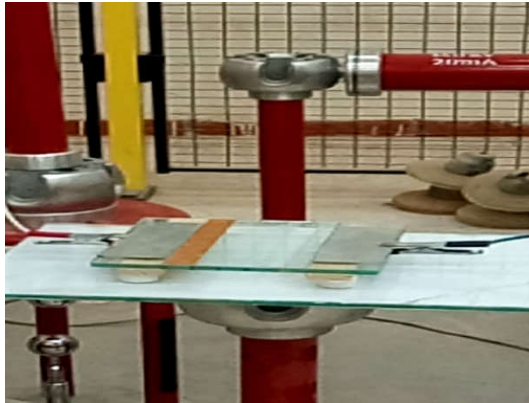
Figure III.39. Photo pollution en Argile coté ht, (a) largeur de pollution 2cm et (b) contournement du modèle polluée
