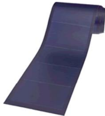
Figure I.18: Module photovoltaïque souple au silicium amorphe \alpha Si triple jonction pour une efficacité de 6,5% (photo Unisolar). [14]
