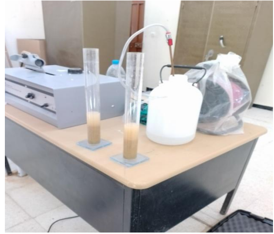
الصورة II - 3 - توضح تجربة المكافئ الرملي
