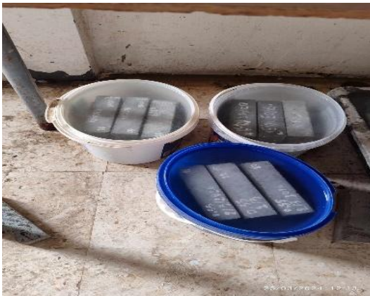
الصورة III -9- توضح العينات في ماء السبخة
