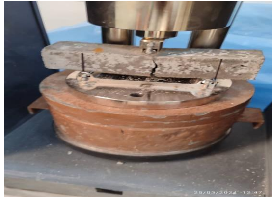
الصورة 3-15- توضح عملية التحطيم بالانحناء
