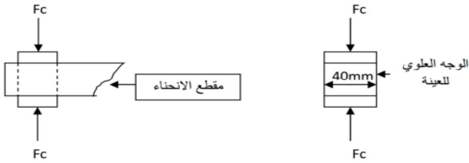
شكل-I-6 يوضح آلية التحطيم بالضغط
