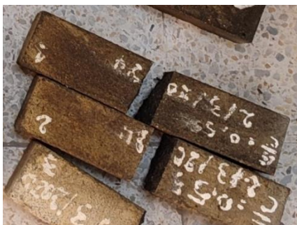
الصورة 2: توضح عينات الملاط المختلفة بعد الغمر
