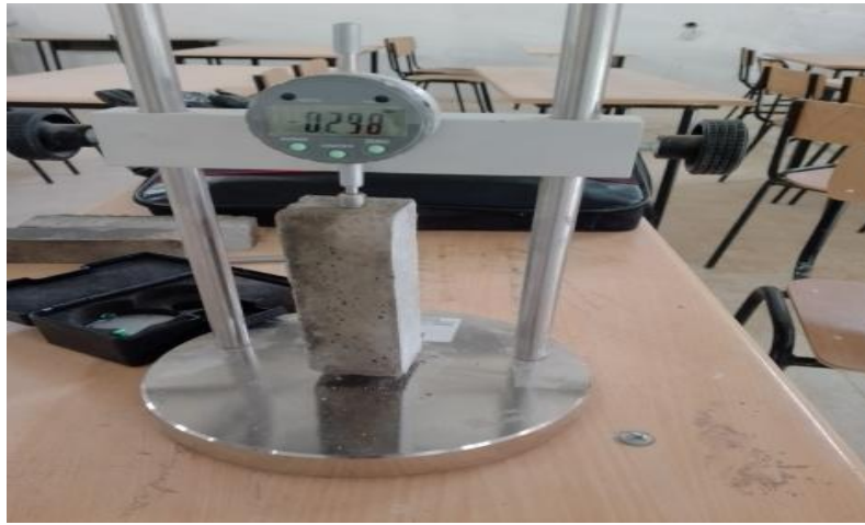
الصورة III- 14 - توضح عملية قياس الانكماش
