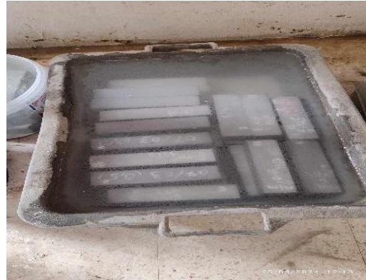
الصورة III-10- توضح العينات في ماء عادي(ماء الحنفية)
