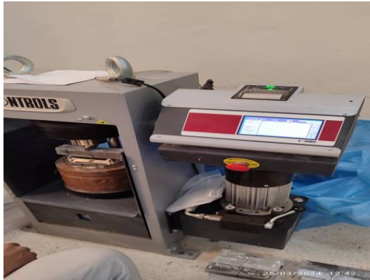
الصورة 3-15- توضح عملية التحطيم بالانحناء
