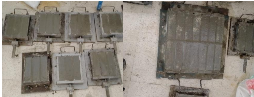
الصورة III-7- توضح عملية الصب
