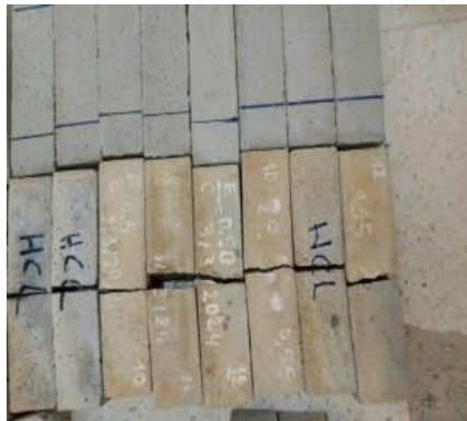
الصورة- III-18- توضح تأثير HCl بنسبة 0.3% على العينات بعد 45 يوم
