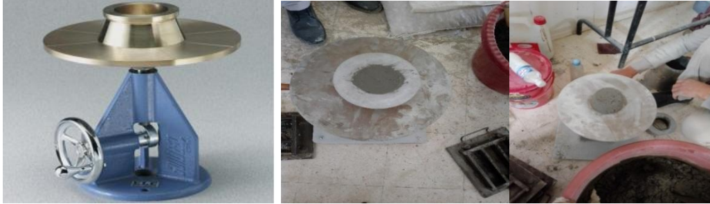
الصورة III-2- توضيح طاولة الانتشار و قياس التشغيلية
