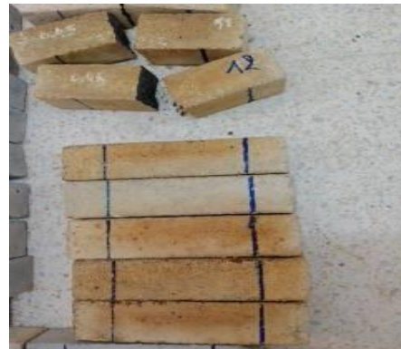
الصورة- III-18- توضح تأثير HCl بنسبة 0.3% على العينات بعد 45 يوم
