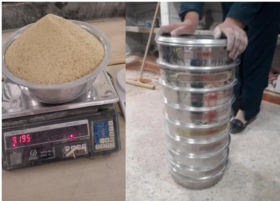
الصورة- II -5- توضح التدرج الحبيبي
