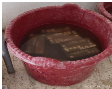
الصورة 1: توضح عينات الملاط المختلفة مغمورة في محلول CH_3COOH
