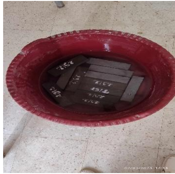
الصورة III-12- توضح العينات في ماء بمحلول HCl
