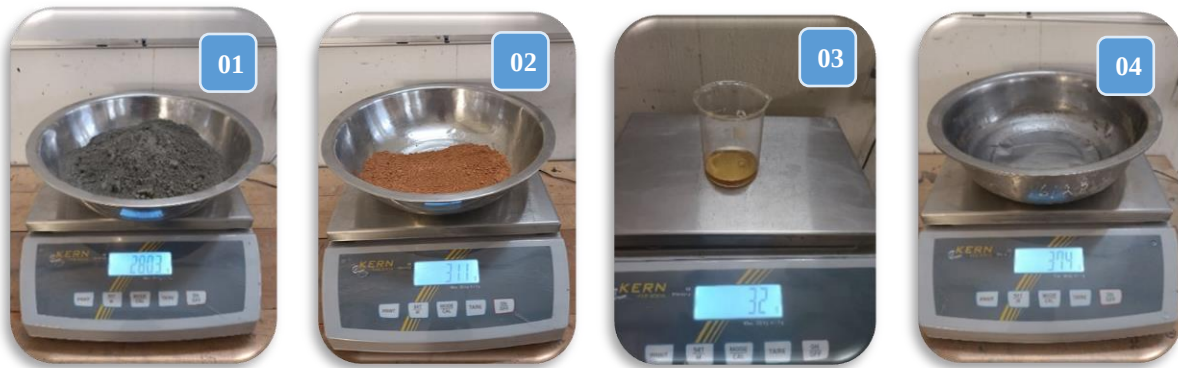
Figure II.12. Ciment (01), Poudre de céramique (02), Eau de gâchage (03), Superplastifiant (04)
