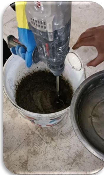
Figure II.15. Mélanger le mélange de béton avec un mélangeur à peinture.
