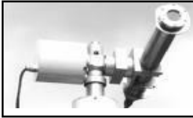
شكل (7-1): جهاز يقيس الإشعاع الشمسي المباشر (pyrheliometre)
