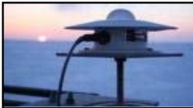
شكل (1-6): جهاز يقيس الإشعاع الكلي لضوء الشمس
