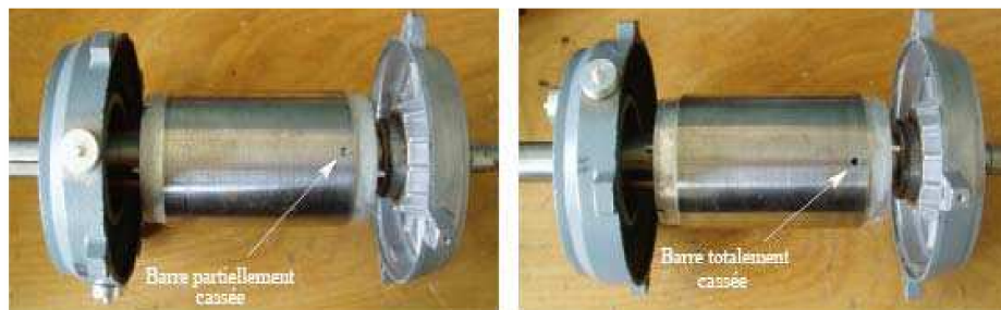
Fig I.3: Défaut de cassure de barre rotorique.
