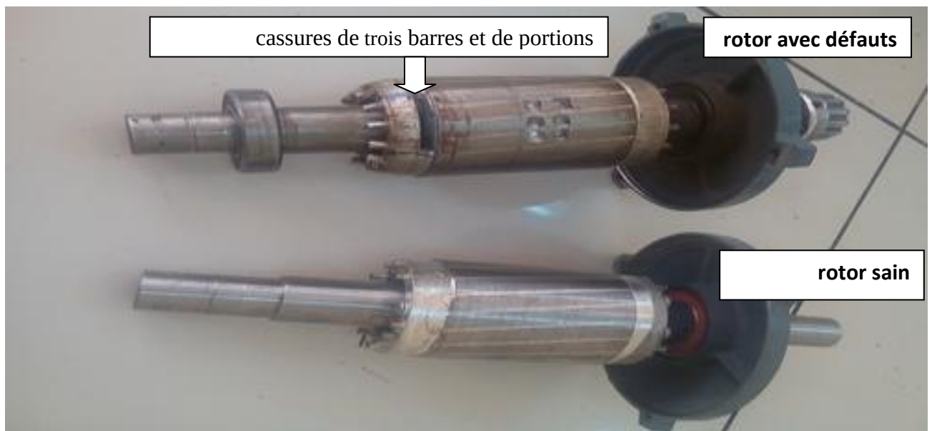
Figure I.5: Cassures de barres et de portions d'anneaux (laboratoire de la faculté de technologie- université d' El Oued).
