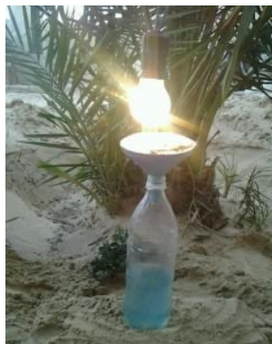
Figure 21: L'appareil de berlese ( original 2014 ).
