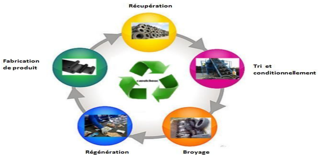
Figure I.7 :Processus de recyclage de déchets de caoutchouc
