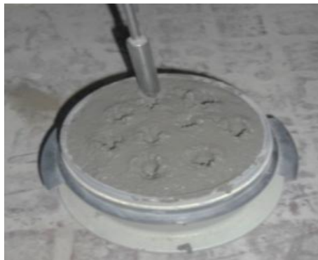
Figure II.15. Mise en place de la deuxième couche
