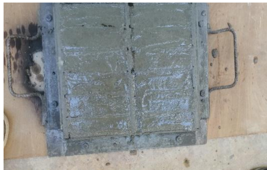
Figure II.10. Remplissage total et vibration
