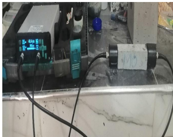
Figure II.21. Mesure de la vitesse de propagation de sons sur des éprouvettes (4x4x16) cm 3
