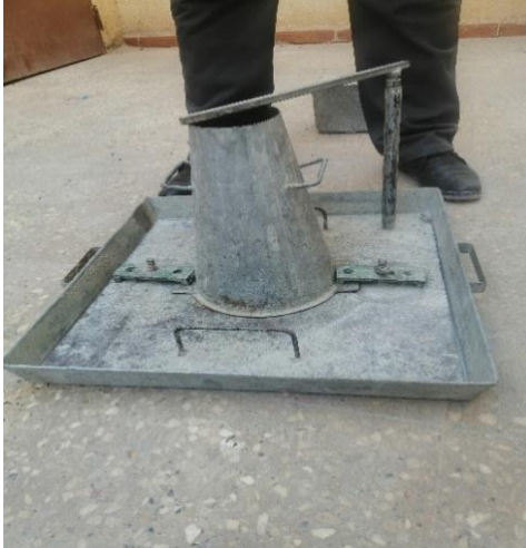
Figure II.13a. L'essai d'affaissement au cône d'Abrams avant le démoulage.
