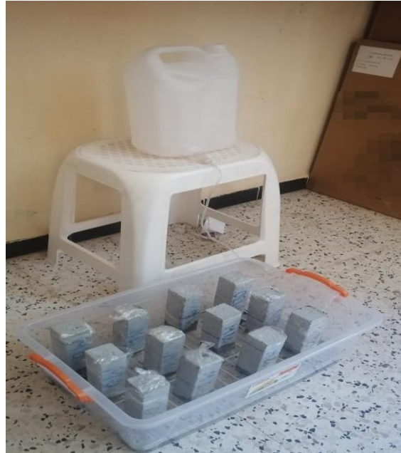
Figure II.18 Dispositif de l'essai d'absorption d'eau par capillarité
