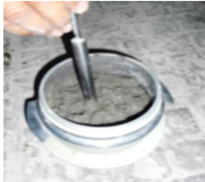
Figure II.14. Mise en place de la première couche
