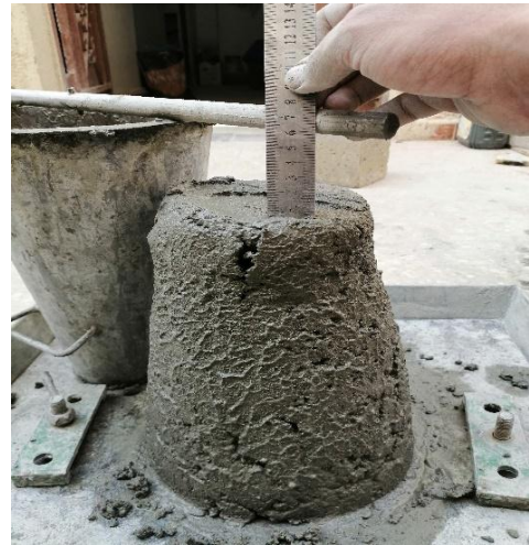
Figure II.13b. L'essai d'affaissement au cône d'Abrams après le démoulage.
